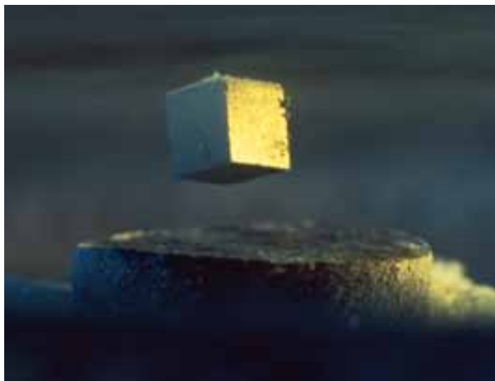
Ein Experiment, das als Symbol um die Welt ging: Ein Magnet schwebt über einem mit flüssigem Stickstoff gekühlten Hochtemperatur-Supraleiter.
