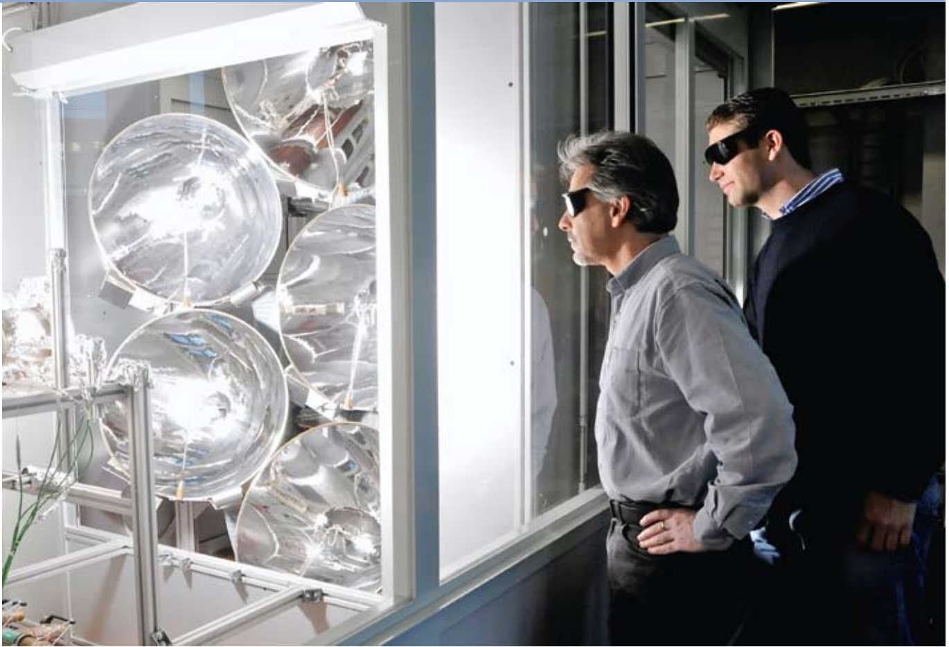
Aldo Steinfeld, Professor für Erneuerbare Energieträger an der ETH Zürich und seinem Team ist es gelungen einen Solar-Reaktor zu entwickeln, der Benzin, brennbares Gas, aus Sonnenlicht produziert. Auf dem Bild sieht man, wie Professor Steinfeld und sein Doktorand Philipp Furler ein Experiment am Solarsimulator verfolgen, der mit Sonnenlicht Kohlendioxid und Wasser zu Synthesegas umsetzt. Dieses wird zu Benzin weiterverarbeitet.
