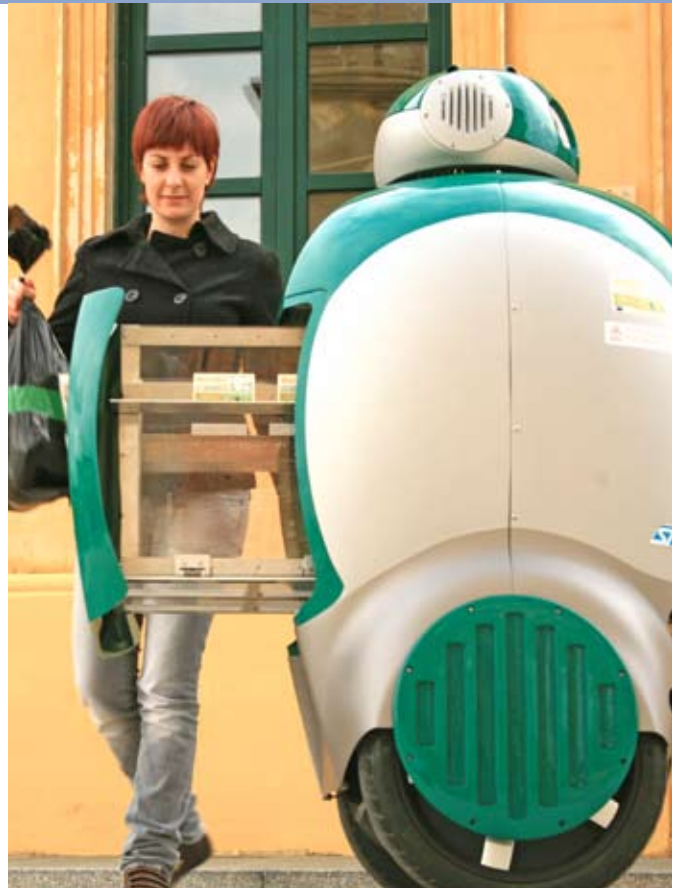
Die Roboter namens Dustcart und Dustclean können nicht nur Strassen fegen, sondern auch zwischen organischem, Plastik- und sonstigem Müll unterscheiden.
