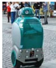
Die Roboter namens Dustcart und Dustclean können nicht nur Strassen fegen, sondern auch zwischen organischem, Plastik- und sonstigem Müll unterscheiden.
