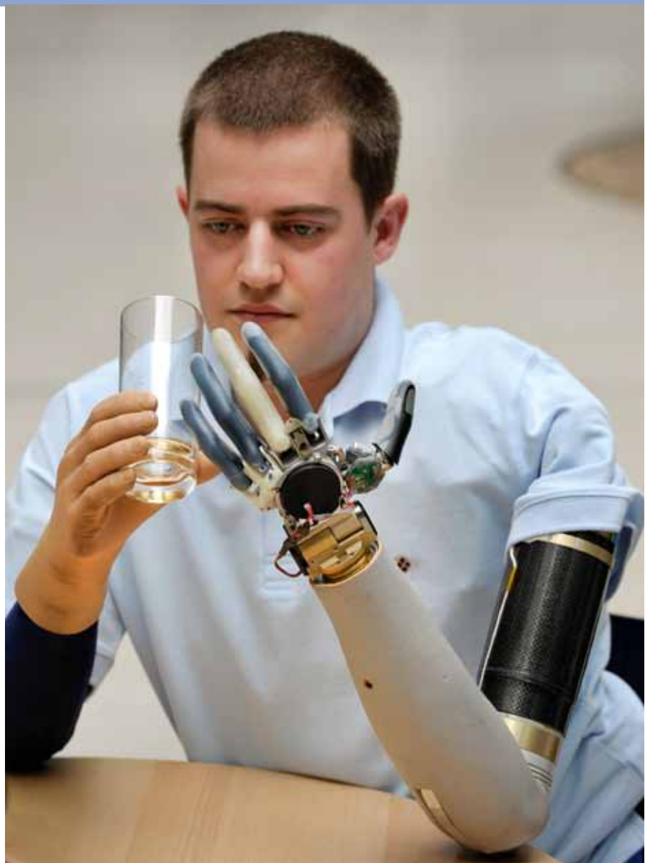
Christian Kandlbauer verfügt über eine gedankengesteuerte Armprothese Diese wird rein durch Nervenimpulse gesteuert.
