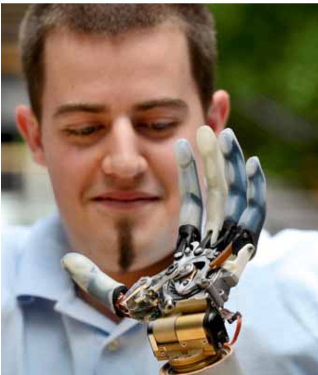
Der 20-Jährige verlor bei einem Unfall beide Arme. Rechts bekam er eine herkömmliche Prothese, links trug er den Prototyp einer neuartigen Prothese, die Gedanken lesen konnte. Dachte er «Faust ballen», führte die Prothese dies selbstständig aus.
